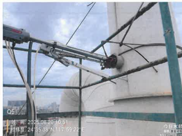
2#氰化氢、硫酸雾排气筒 DA006 出口(点位:◎5)
