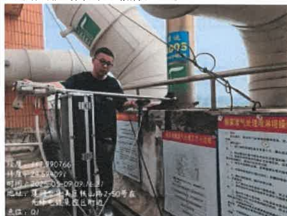
热水炉排气筒出口(点位:◎1)
